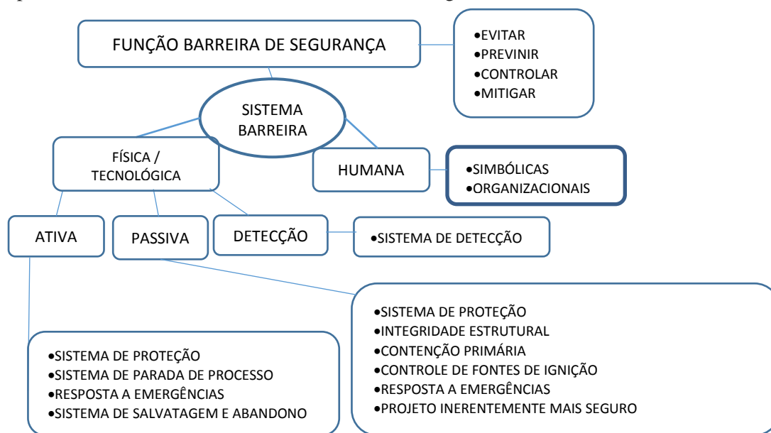
Figura 5: Fluxograma para classificação de funções de barreiras e sistemas de barreiras.
