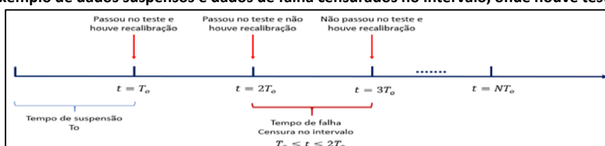
Figura 5 - Outro exemplo de dados suspensos e dados de falha censurados no intervalo, onde houve teste sem calibração.
