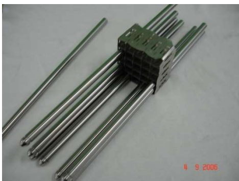
Figura 6 – Tubos com tampão sendo inseridos na seção de grade fixadora
