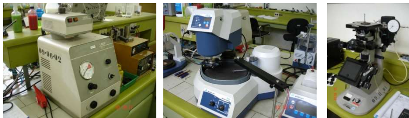
Figura 8 – Equipamentos Utilizados: Prensa, Polidor e Microscópio com régua
