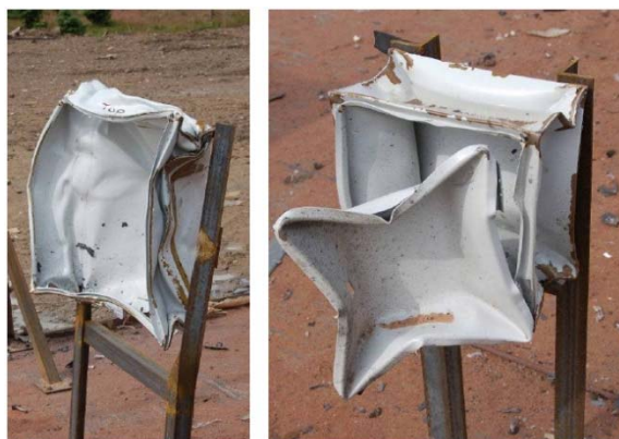
Fig.8 – Típicas deformações em caixa de elétrica
