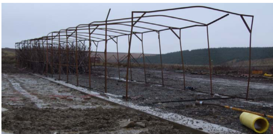
Fig.5 – Dispositivo após teste, sem o filme de polietileno para conter nuvem de vapor
