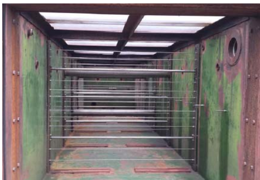
Fig.2 - Dispositivo de teste com tubos de diferentes diâmetros, para verificar a contribuição de cada dimensão para a turbulência
