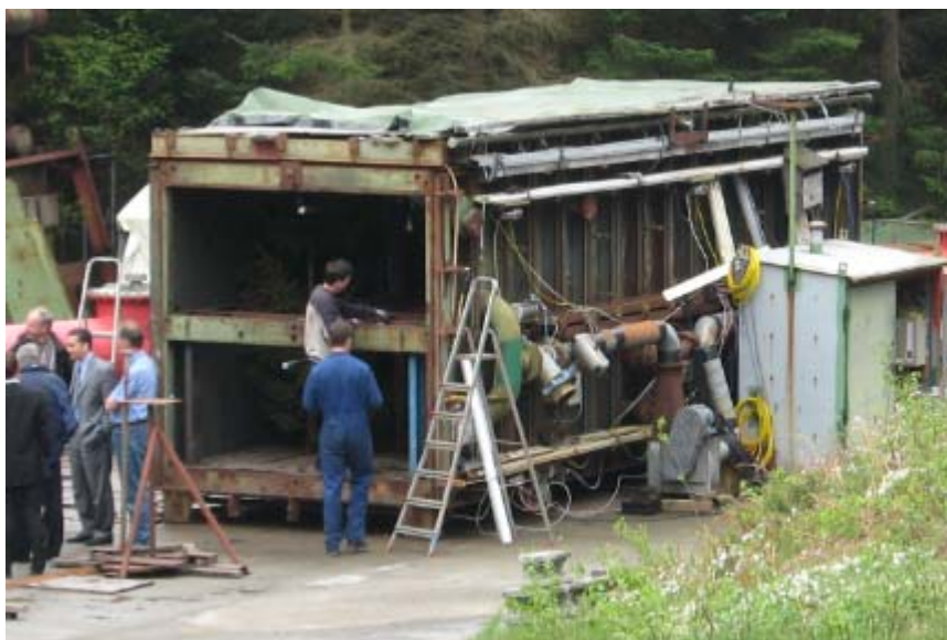
Fig.4 – Container de teste de explosão, vista da face de ventilação.
