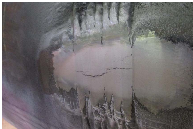
A – trinca restrita à solda do coletor de alta pressão.
