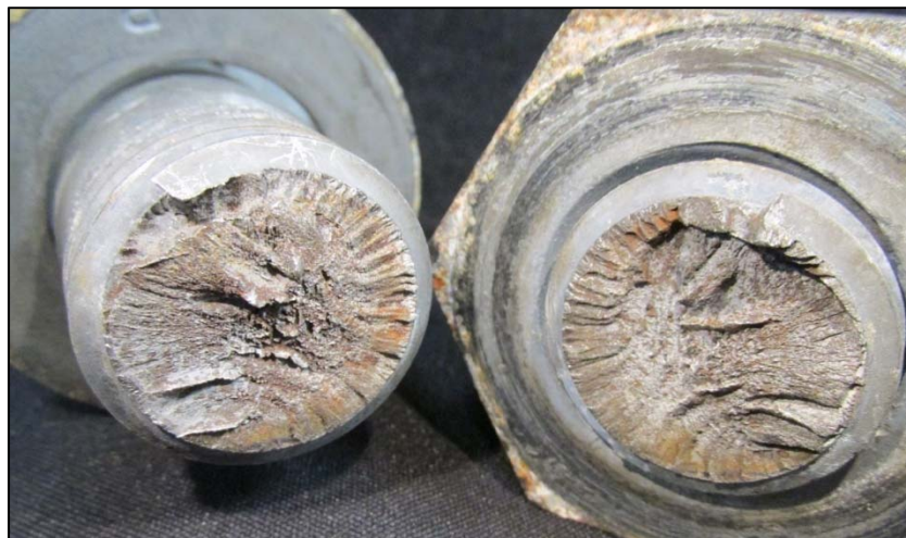
A – Parafuso de alta resistência rompido em operação. Dois lados da fratura (cabeça à direita).
