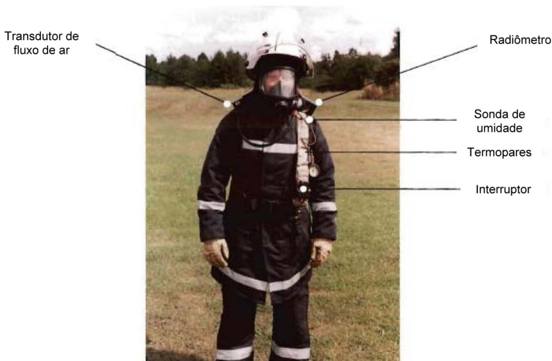
Figura 4 – Sensores instalados na roupa de proteção do bombeiro [5]
