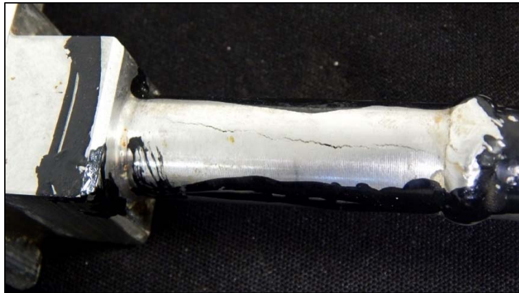
A – Superfície externa do conector submarino com trinca longitudinal, iniciada no interno.
