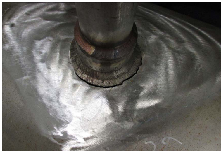
A - Ramificação em tubulação, rompida na margem da solda.
