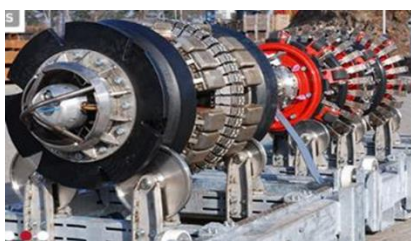
Fig. 16 – PIG de inspeção por ultrassom
