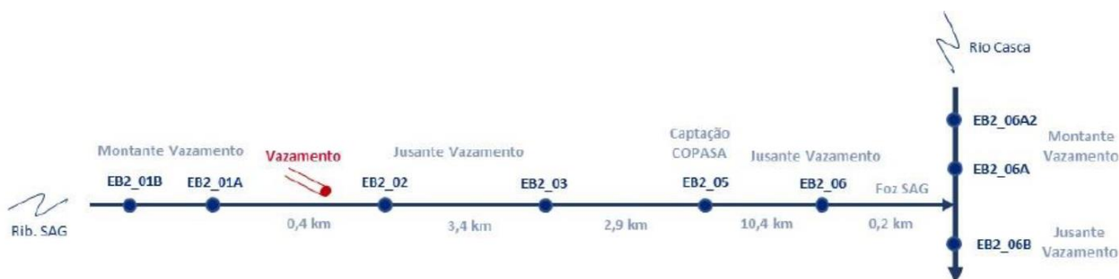
Fig. 20 – Esquema gráfico dos Pontos de Monitoramento de Qualidade da Água
