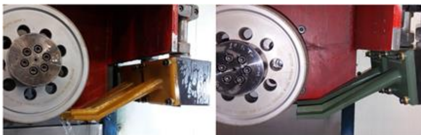
Fig. 2 – Setup para testes iniciais com bicos refrigerantes fabricados em ULTEM 1010 (esquerda) and ABS (direita).
