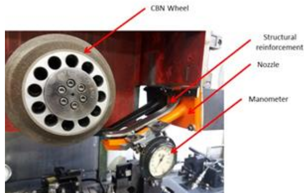
Fig. 8 – Setup na retífica creep feed.
