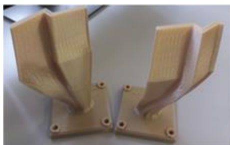
Fig. 3 – Bicos refrigerantes impressos em ULTEM 9085.
