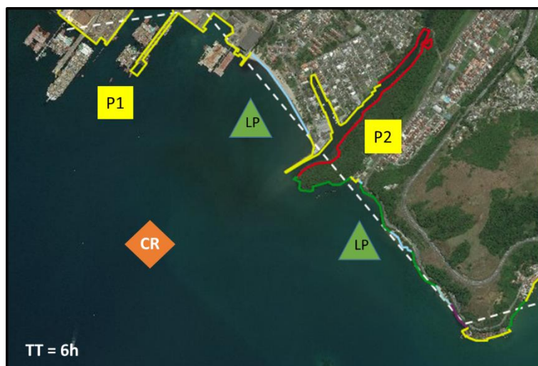
Figura 6 – Exemplo de esquemático tático para receptor crítico identificado a partir da modelagem de deriva de mancha e dos enquadramentos de criticidade e de nível de exigência (à esquerda) e tempos de resposta para cada uma das ações a serem desempenhadas, a saber: P1 = proteção de área vulnerável 1; P2 = proteção de área vulnerável 2; LP = limpeza de praia; e CR = contenção e recolhimento nearshore.
